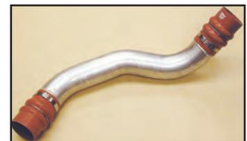
Ensamble de tubo de carga de aire acondicionado
